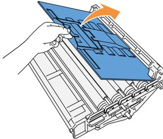
2. Halten Sie die Bildtrommel so am Griff, dass der abgeflachte Teil zur Druckerrückseite zeigt, und richten Sie die Kunststoff-Führungen an beiden Seiten der Bildtrommel auf die Aufnahmeschlitz vor den Pfeilen am Drucker aus.
