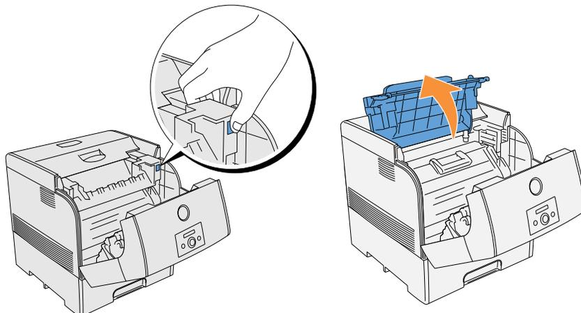
3. Fassen Sie die Bildtrommel am Griff an, und ziehen Sie sie nach oben heraus.
