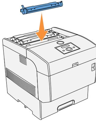
4. Halten Sie die Hebel an beiden Enden der Tonerkassette, und drücken Sie sie fest nach unten, um sie nach vorne zu drehen.
