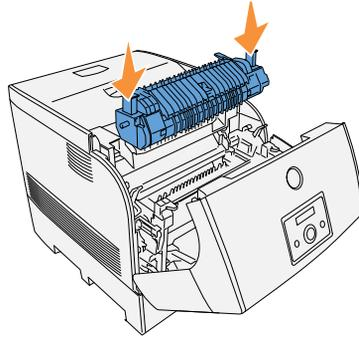
2. Halten Sie die Fixiereinheit an den Griffen fest, schieben Sie sie vollständig nach unten in den Drucker ein, bis die Hebel an beiden Seiten der Fixiereinheit in ihre ursprüngliche Position zurückkehren.
