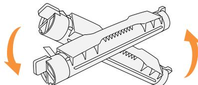
3. Richten Sie die Tonerkassette auf die entsprechende Kassettenhalterung im Drucker aus, und setzen Sie sie ein.
