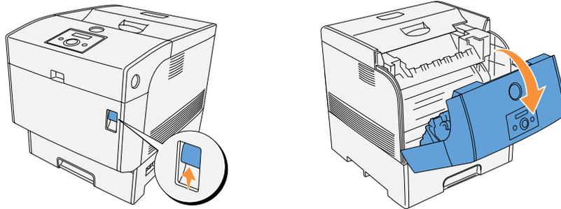
2. Drücken Sie den Knopf wie in der folgenden Abbildung dargestellt, und öffnen Sie die Bildtrommelabdeckung.
