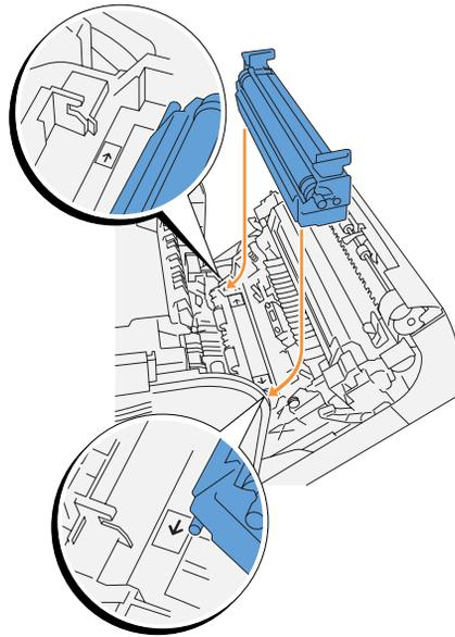
7. Arretieren Sie die Übertragungswalze im Drucker, indem Sie die Laschen nach unten drücken, bis Sie sie einrasten hören.
